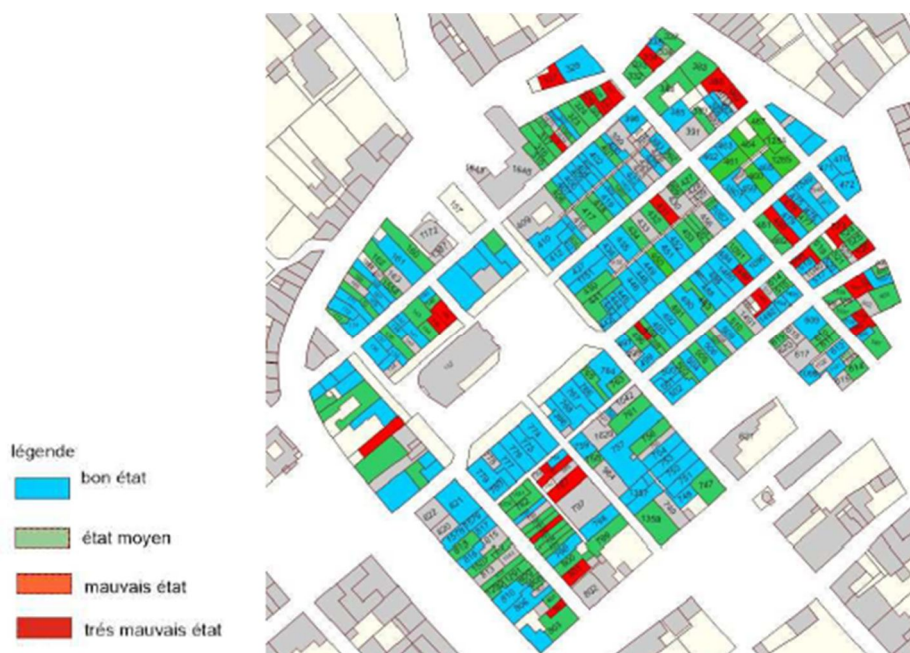
Figure 2 : Très grande hétérogénéité dans l'état du bâti à l'échelle de Réalmont,
